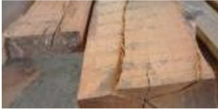
Figura 5. - Presencia de rajaduras en piezas aserrada de las especies estudiadas
