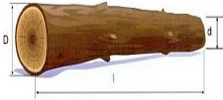
Figura 2. - Determinación de la conicidad de las trozas. Representação gráfica da conicidade de toras
