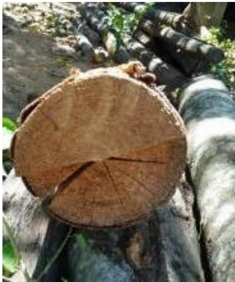
Figura 4. - Presencia de rajadura en extremo de una troza de Toona ciliata
