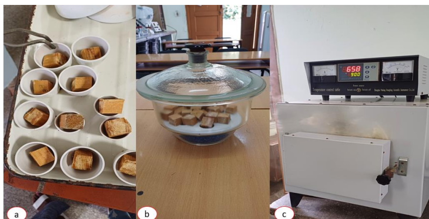
Figura 3. - Materiales y equipos de laboratorio. a- crisoles, b- desecador, c-mufla
